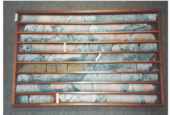
Caja conteniendo testigo de un sondeo
