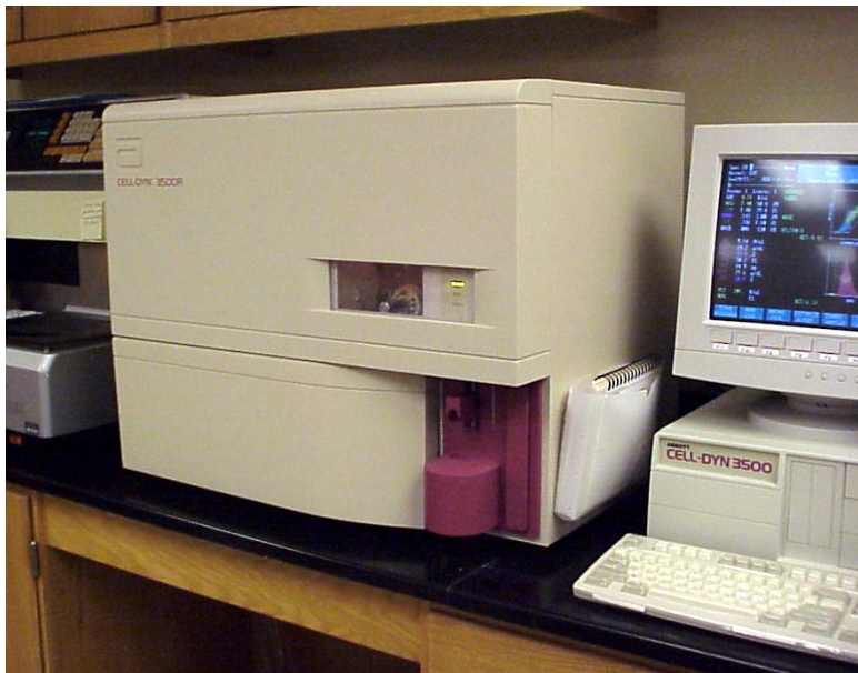
Figura 16.- Cell-Dyn 3500R Analizador hematológico automático; Abbott Laboratories, Abbott Park, IL, USA.
