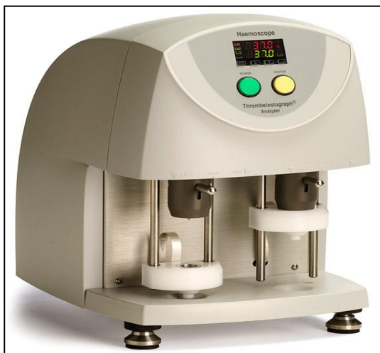
Figura 17.- TEG® 5000 Tromboelastógrafo; Analizador de la coagulación; software versión 4.2.2 (Haemoscope Corporation, Nilus, IL, USA).
