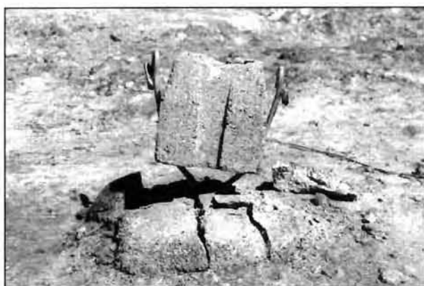
Figura 7.- Pilote tipo 1 tras la realización del ensayo.
