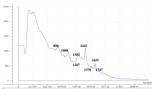
Figura 1. Espectro Raman de aceite de oliva mediante espectrometría Raman dispersiva
