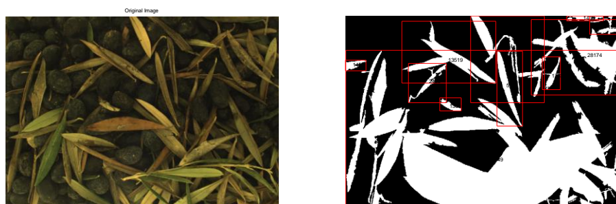
Figura 1. Imagen original (a) e imagen después de la segmentación basada en el color, que muestra los resultados expresados como el área de píxeles ocupada por las hojas (b).
