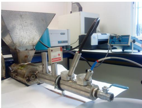
Figura 1. Sistema diseñado para este trabajo con el fin de tomar las mediciones Raman de pasta de aceituna
