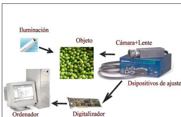
Figura 10. Componentes de un sistema de visión artificial
