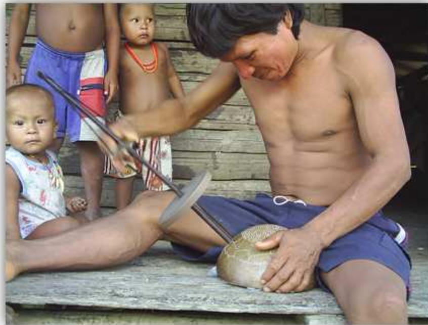
Figura 6.18. Herramienta tipo taladro empleada por los indígenas de la comunidad Embera de Puerto Samaria, que funciona en forma mecánica, accionada en el movimiento de dos cuerdas entorchadas en un eje con contiene un disco pesado para hacer constante el movimiento. Por: autor (Proyecto mejoramiento organizativo de la asociación de autoridades indígenas de Bajo Baudó ASAIBA, 2006).
