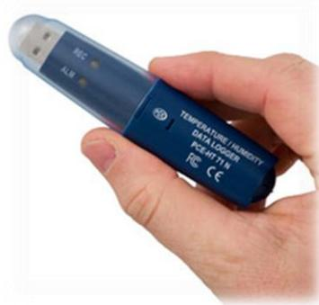
Fig. 13. Datalogger para registro de temperatura y humedad relativa
