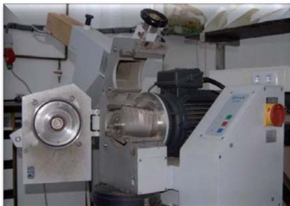
Figura 2: Molino de materia prima Retsch 2000.
