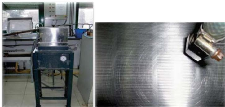
Figura 5: Separador de fibras e incocidos.
