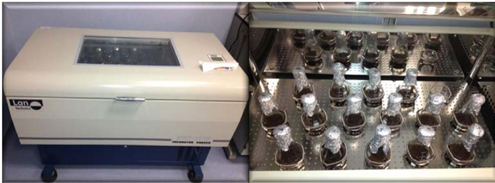
Figura 14: Agitador orbital.
