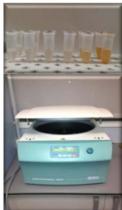
Figura 15a. Centrifugación de alícuotas.
