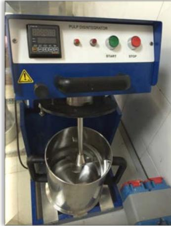
**Figura 8:** Desintegrador de pastas celulósicas.
