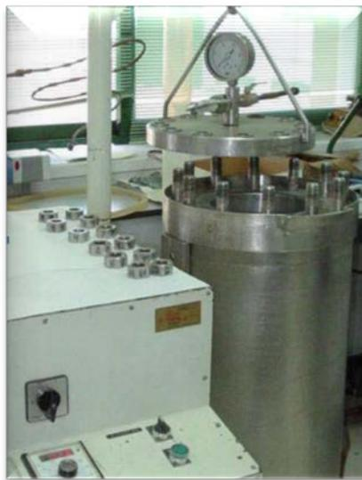
Figura 3: Digestor para obtención de pastas.
