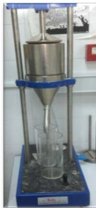
**Figura 9:** Refinómetro Schopper-Riegler.
