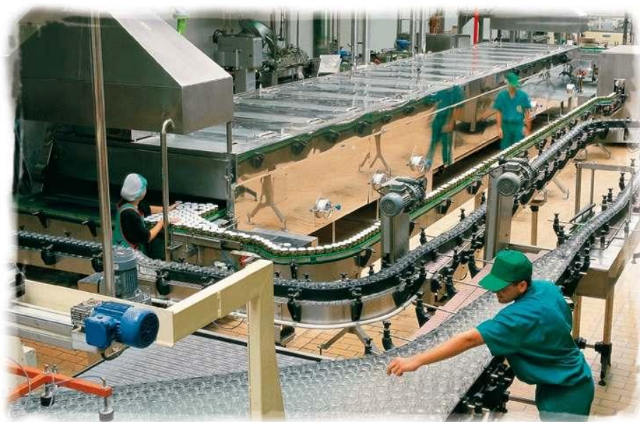
FIGURA 20 - LÍNEA DE ENVASADO DE TARROS Y TÚNEL DE PASTEURIZACIÓN
