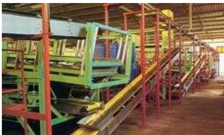
FIGURA 6 - MAQUINARIA PARA EL CALIBRADO DE LA ALCAPARRA
