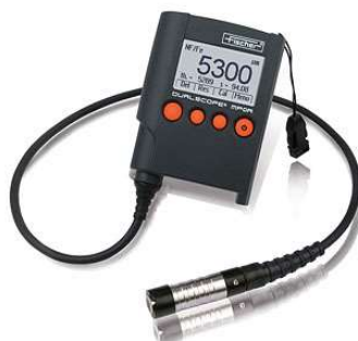
Figura 3. Medida de espesor Fischer MPOR-FP .
