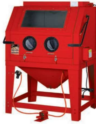
Figura 5. Cabina de chorreado Sandblast Cabinet CAT-990.
