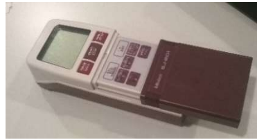
Figura 2. Rugosímetro Mitutoyo SJ-201.
