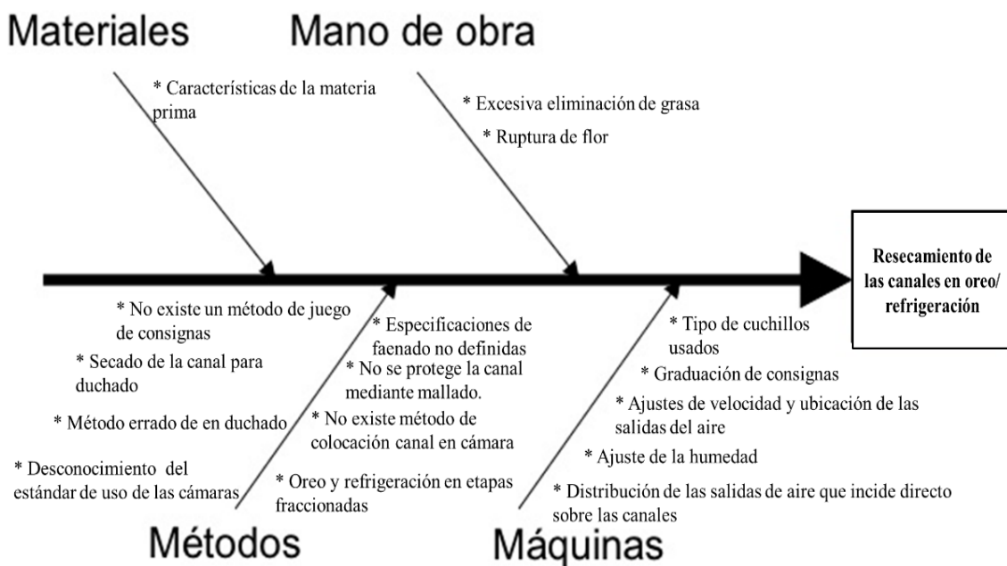
Figura 5.1. Diagrama de Ishikawa para el defecto resecamiento de las canales en matadero.
