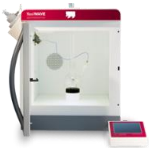
Figura 7. Envejecimiento de un HDL asistido por microondas
