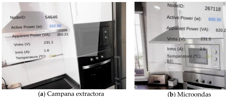
Figura 4-17. Información de energía aumentada que se muestra en la pantalla del teléfono inteligente.
