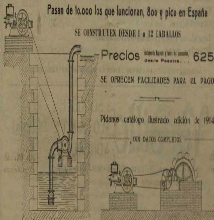
Instalación de Bomba Centrifuga
