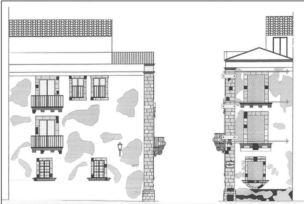
**Figura 82** - Rilievo dello stato di degrado nel prospetto lato di Ronco Spiraglio (a sinistra) e di Via Vittorio Veneto (a destra). Fonte: progetto dell'Arch. E. Giliberti
