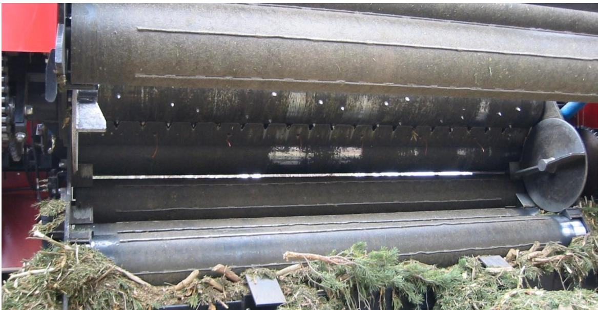
Foto 40: Sistema de inyección de hilo
