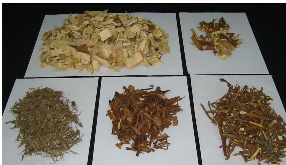
Foto 37: Componentes de fracción gruesa de bala astillada
