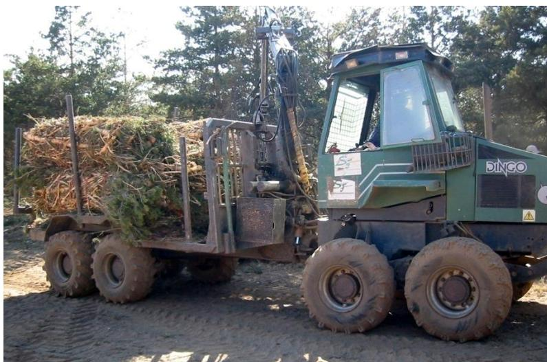
Foto 47: Saca de balas con autocargador
