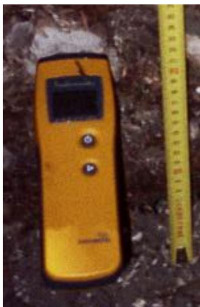
Foto 35: Medición de humedad con higrómetro
