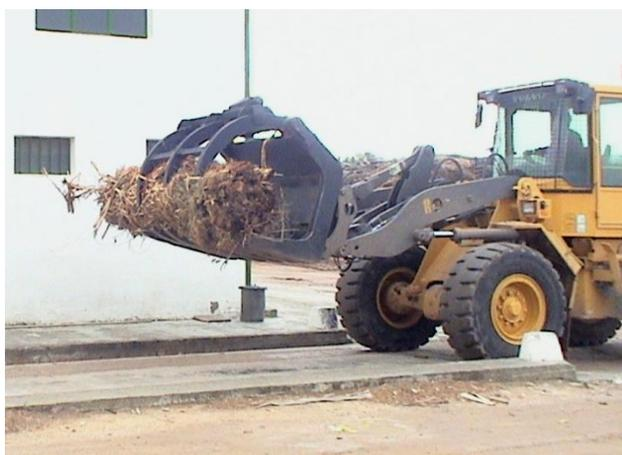
Foto 13: Transporte para pesado de bala en báscula de fábrica
