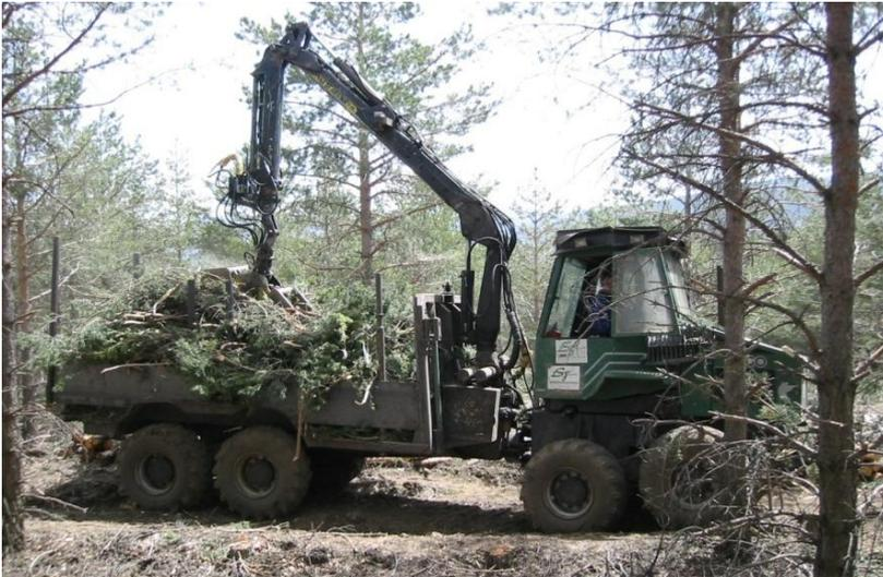
Foto 22: Saca de residuo suelto con autocargador
