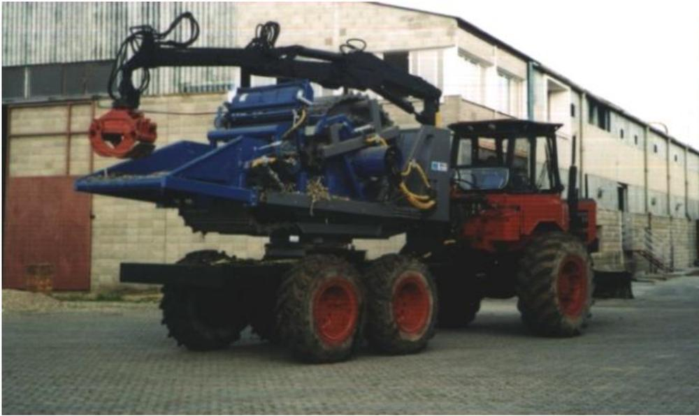
Foto 5: Empacadora Balapress montada en autocargador Kockum
