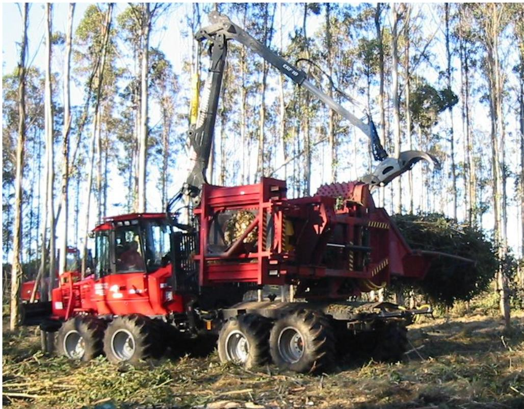
Foto 6: Empacadora MONRA ENFO 2000 montada en autocargador Valmet
