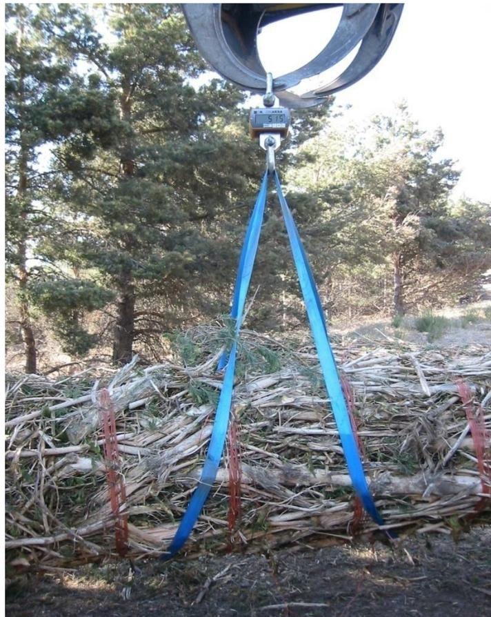
Foto 12: Pesado de bala con dinamómetro
