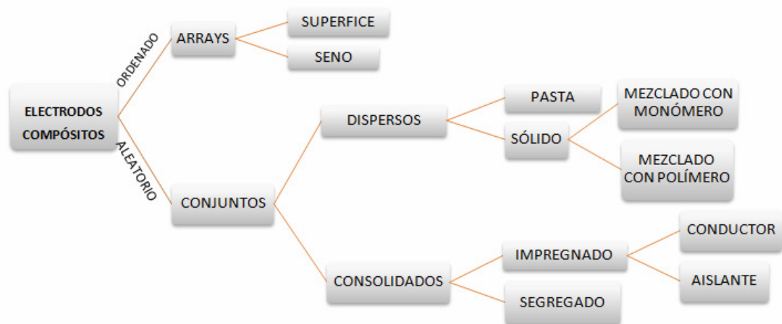
Figura: 20. Clasificación de los electrodos compósitos.
