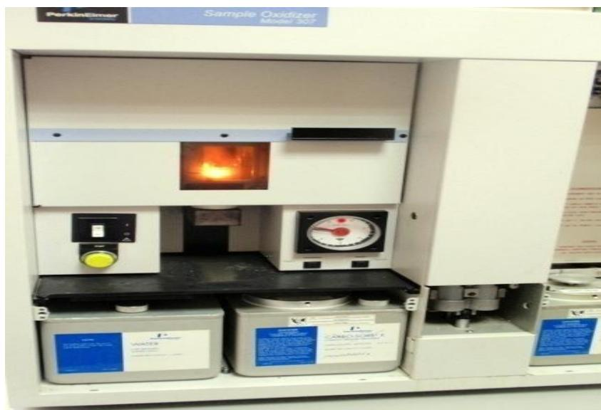
**Fig. 2.5.** Combustion de muestras en el oxidador biológico.
