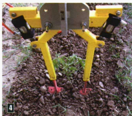
Foto 3. Cuchilla GPS cerrada eliminando la mala hierba existente entre plantas de tomate (Fuente: University of California, Davis). Foto 4. Cuchilla GPS abierta saltando la planta de tomate (Fuente: University of California, Davis).
