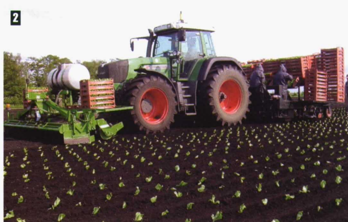
Foto 1. Maíz sembrado en círculo bajo pivót con un sistema RTK-GPS (Fuente: Trimble Navigation). Foto 2. Preparación del terreno y plantación de lechuga con un sistema guiado automático RTK-GPS (Fuente: Trimble Navigation).
