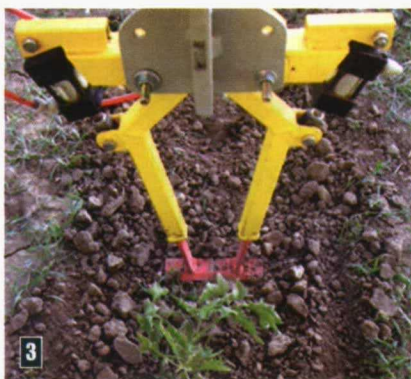
Foto 3. Cuchilla GPS cerrada eliminando la mala hierba existente entre plantas de tomate (Fuente: University of California, Davis). Foto 4. Cuchilla GPS abierta saltando la planta de tomate (Fuente: University of California, Davis).
