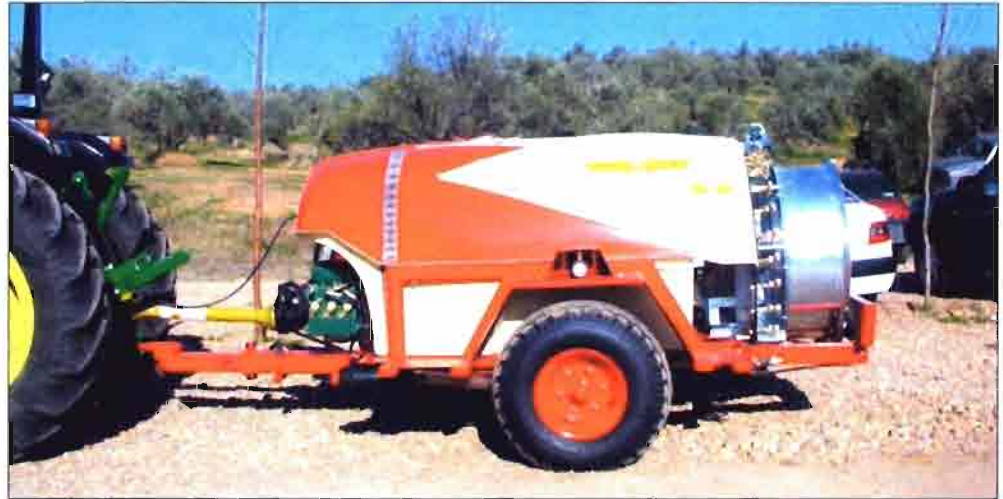
Foto 14 (izda.). Distribución de boquillas para mejorar la adaptación al olivo. Foto 15 (arriba). Atomizador con sistema de detección de presencia de olivo.
