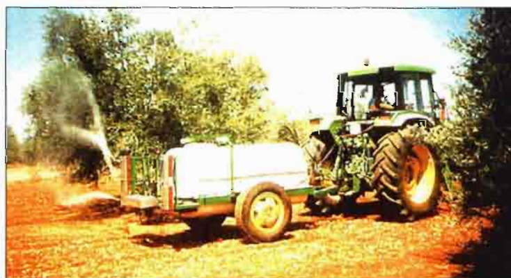
Foto 11. Boquillas móviles que simulan el trabajo de las mangueras.
