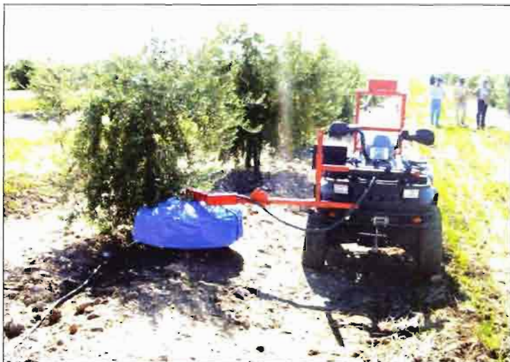
Foto 9. Equipo centrífugo de Ultra Bajo Volumen trabajando los pies.
