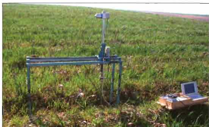
Foto 4. Penetrómetro de accionamiento eléctrico y lectura informatizada.
