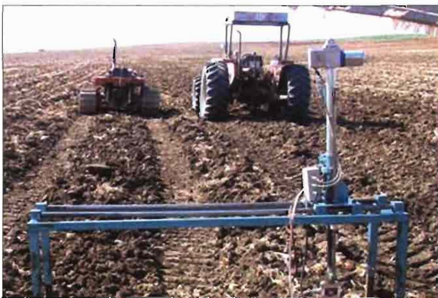
Foto 6. Estacionamientos en campo con el penetrómetro para medición transversal a las huellas.
