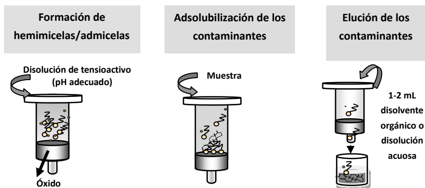
Figura 2.2.c Procedimiento operativo para la extracción de analitos en muestras acuosas con el uso de adsorbentes supramoleculares
