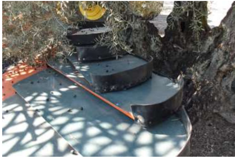
Figura 89. Detalle del sistema de contacto del prototipo con el tronco del olivo durante su recolección
