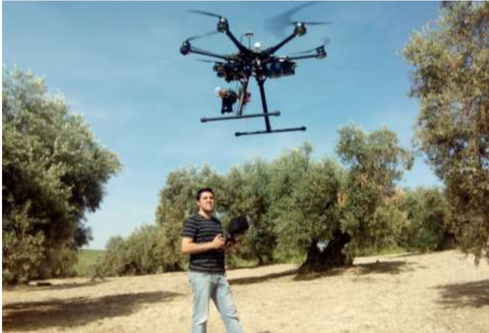
Figura 36. Elevación de UAS en olivar para la obtención de fotografías aéreas antes de la puesta en modo automático
