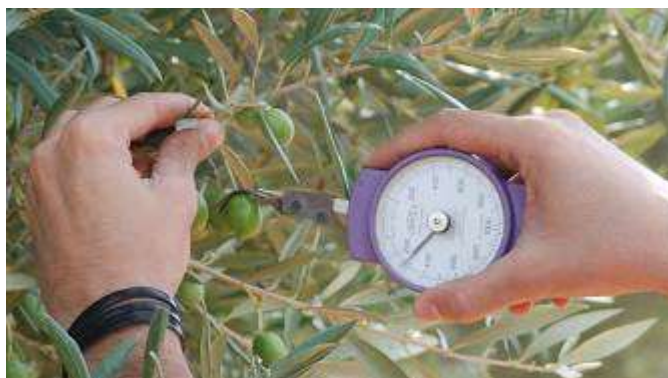
Figura 16. Dinamómetro adaptado para medidas de Fuerza de Retención del Fruto (FRF)
