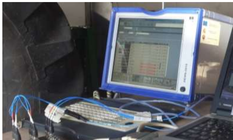
Figura 22. Equipo utilizado para el análisis y registro de las señales de los sensores de caudal y presión
