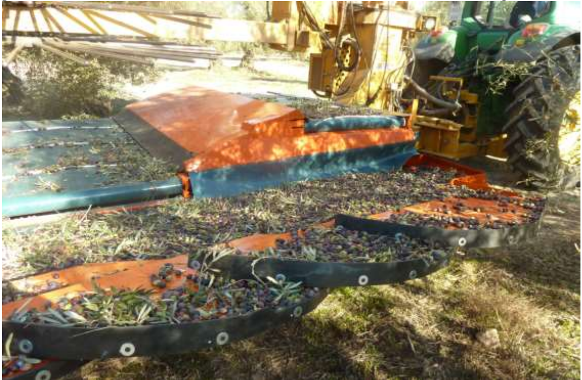
Figura 91. Detalle del sistema de interceptación de fruto tras un árbol recolectado del prototipo desarrollado para la recolección integral con el sacudidor Oxbo 3210
