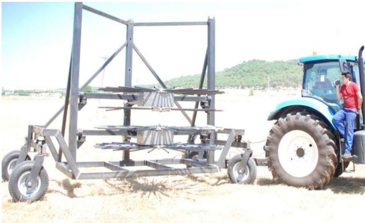
Figura 103. Prototipo SAOLIV 2.1 montado sobre un chasis experimental y arrastrado por un tractor
