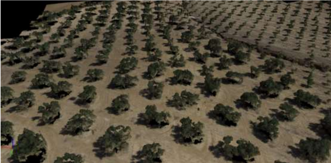
Figura 68. Modelo digital del terreno obtenido con técnicas fotogramétricas con vuelo UAS
