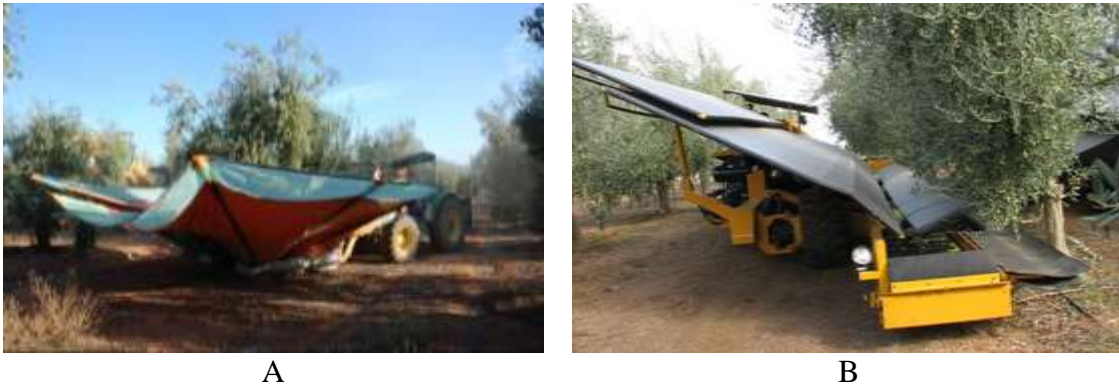
Figura 6. Vibradores de troncos con paraguas invertido (A) y plataformas con planos inclinados (B)
