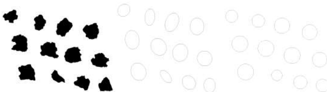
Figura 71. Imagen segmentada y procesado de imagen mediante la técnica de análisis de partículas y generación de elipses y círculos
