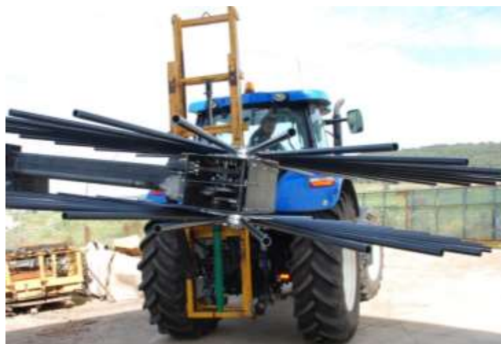
Figura 102. Prototipo SAOLIV 2.1 suspendido en el tripuntal de un tractor
