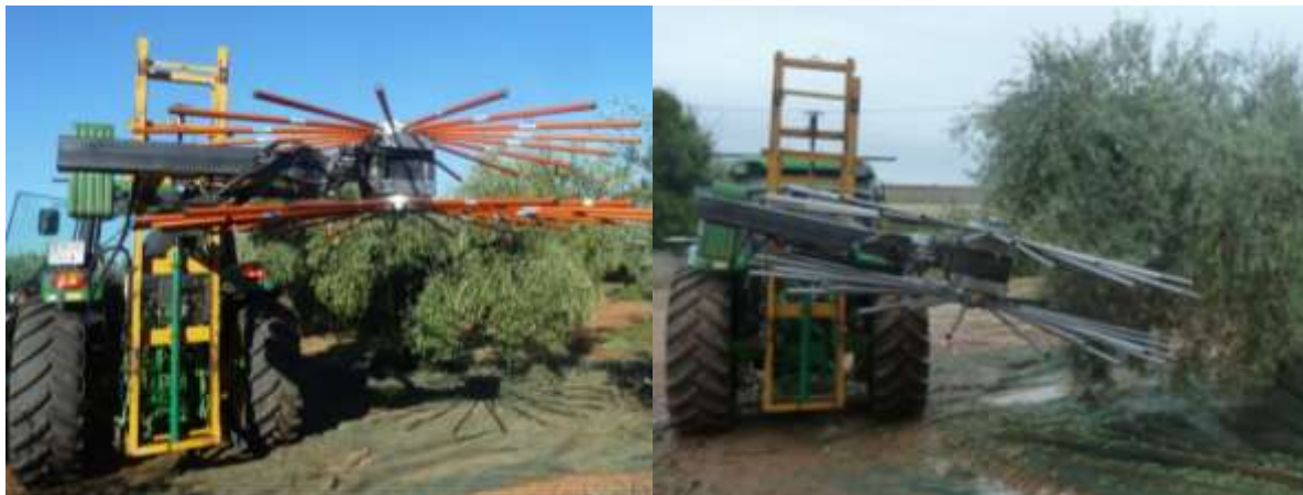
Figura 96. Prototipo SAOLIV 1 en distintas configuraciones de ensayo trabajando en olivar
