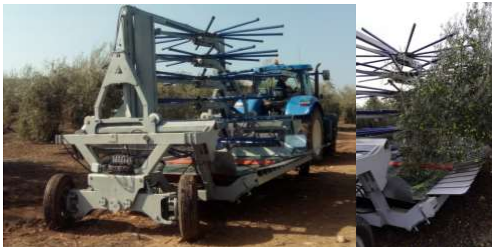
Figura 149. Prototipos sacudidores de copa con sistemas de aproximación, desarrollados para la recolección de naranja (arriba) y aceituna de mesa (abajo)
