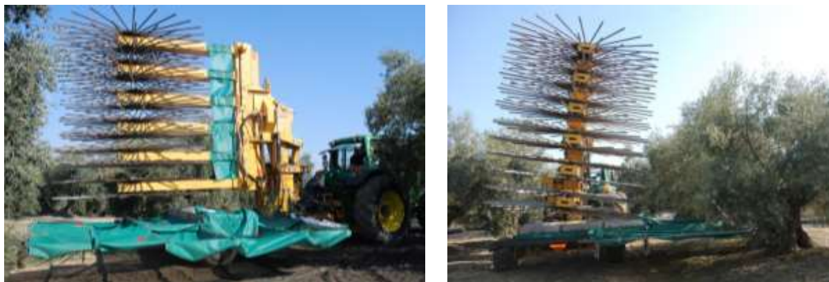
Figura 42. Sistema de interceptación experimental con sectores para la localización del fruto derribado por el sacudidor de copa Oxbo 3210
