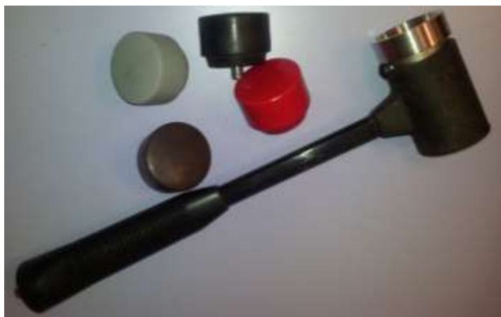
Figura 20. Sensor de martillo de impacto y distintas puntas de golpeo
