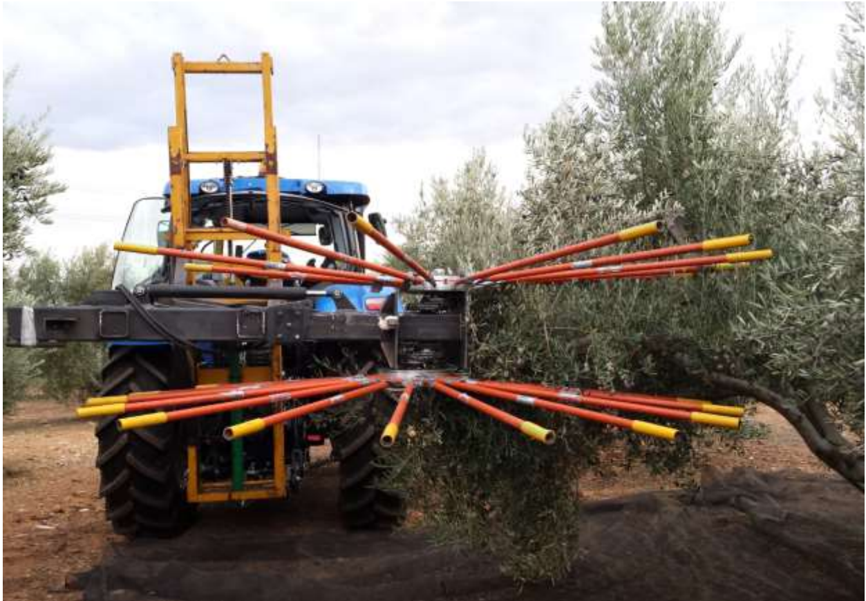
Figura 109. Prototipo SAMOLIV con varas de fibra de vidrio
