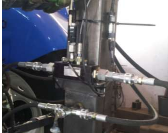
Figura 21. Sensores de caudal y presión en el sistema hidráulico de un prototipo sacudidor de copa
