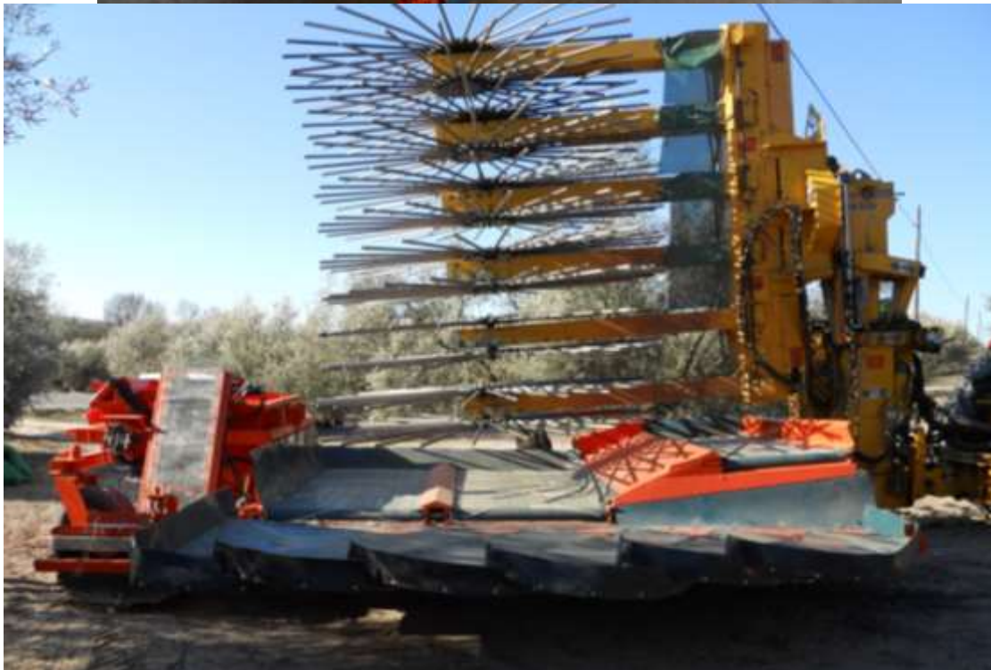
Figura 85. Dispositivo diseñado para la recepción y gestión de fruto derribado por el sacudidor de copa Oxbo 3210
