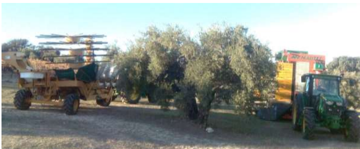
Figura 124. Prototipos precomerciales de cosechadoras basadas en sacudidores de copa para olivar tradicional desarrollados en el convenio Mecaolivar en colaboración con Moresil (izquierda) y Maqtec (derecha)
