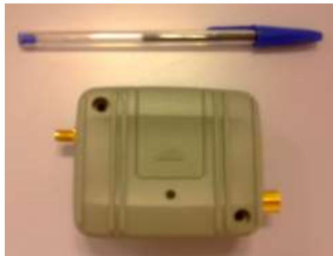
Figura 30. Equipo autónomo de acceso remoto, en el que se aprecian los conectores para la antena GPS (derecha) y para la antena GSM (izquierda)
