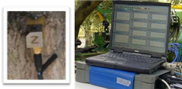
Figura 27. Acelerómetros (izquierda) y equipo analizador de señales dinámicas (derecha) utilizados para la caracterización de la vibración
