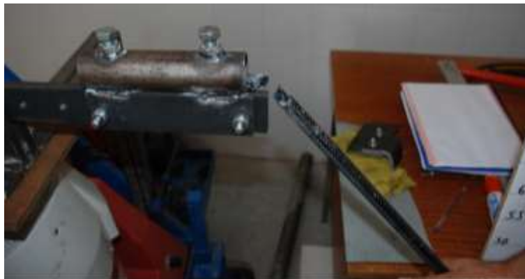
Figura 119. Vara de fibra de carbono maciza rota en el ensayo de simulación de vareo
