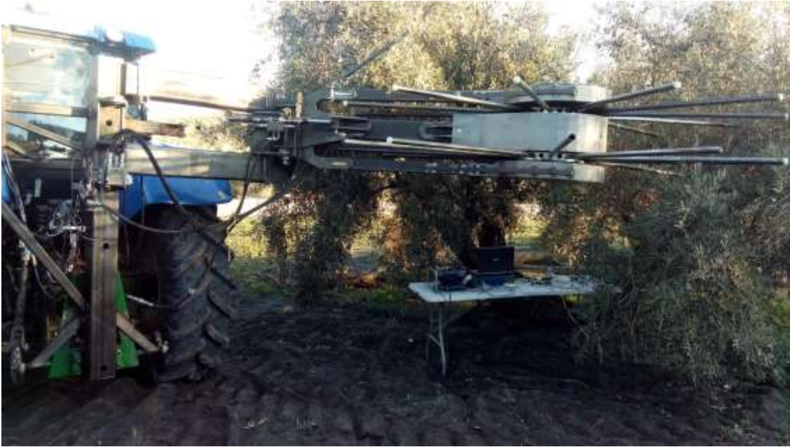
Figura 55. Prototipo SAMOLIV con sistema de automatización experimental de aproximación al árbol
