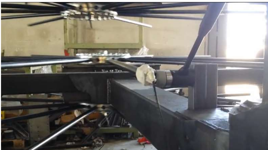
Figura 51. Prototipo SAOLIV 2.1.1. Ensayo de registro de aceleraciones en diferentes partes del mecanismo, con martillo de impacto colocado en la estructura fija de su chasis.
