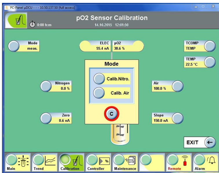
Figura AI.16. Vista del menú calibración “Calibration” de la sonda de pO 2 del software micro-DCU. Selección del modo de calibración del punto cero (“zero”).
