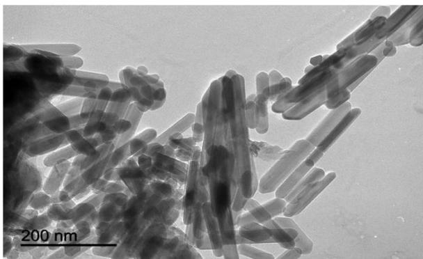
Las celdas de sodio ensambladas con  $\text{Na}_{2/3}\text{Fe}_{1/3}\text{Mn}_{2/3}\text{O}_2$  en forma de nanobarras registraron valores superiores de capacidad durante la descarga y mejor eficiencia coulombica tras 50 ciclos. Por otro lado, los espectros de impedancia compleja mostraron que la morfología de nanobarras es óptima para crear una mejor interfase electrodo-electrolito y resistencias menores durante el proceso de transferencia de carga.
