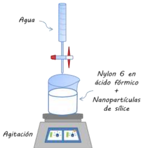
Figura 3. Síntesis del composite de nylon 6 y nanopartículas de sílice.
