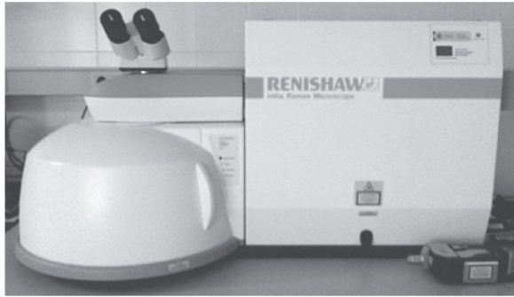
Fig. 11: Espectrómetro Raman empleado en este trabajo.
