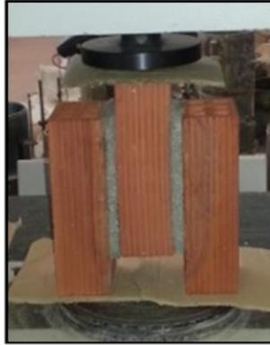
Figura 4.26: Unión entre ladrillo y mortero.
