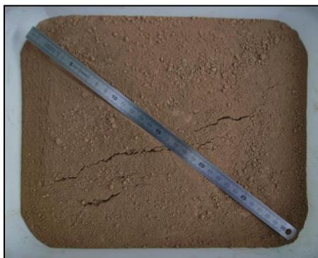
Figura 1.1: Árido reciclado mixto pulverizado (FRMA).
