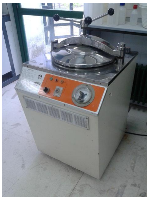
Figura 2.2.1.1. Equipo experimental utilizado para el pre-tratamiento térmico (P Selecta AUTESTER MOD 437-G)
