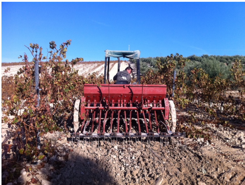
Imagen III-1. Utilización de sembradora convencional para implantar las cubiertas vegetales.
