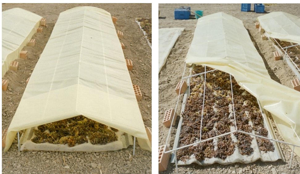
Imágenes IV-8a y IV-8b. Sistema 2 ( S_{CMIP} ). Chapa, malla tradicional e invernadero con plástico sin perforar. (Experiencias segunda anualidad). Fuente: elaboración propia.
