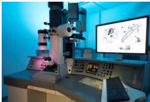
Figura 422. Microscopio electrónico de transmisión ZEIS EM 910
