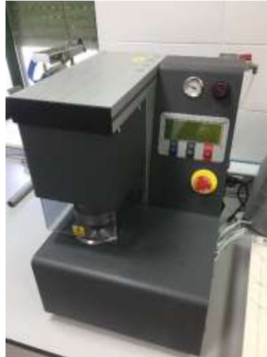
Figura 52. Equipo de determinación de Índice de Estallido (IDMTest)
