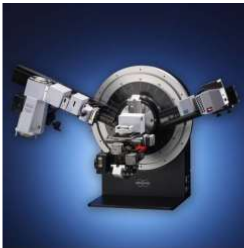
Figura 61. Difractómetro de Rayos X D8 Discover (Bruker)
