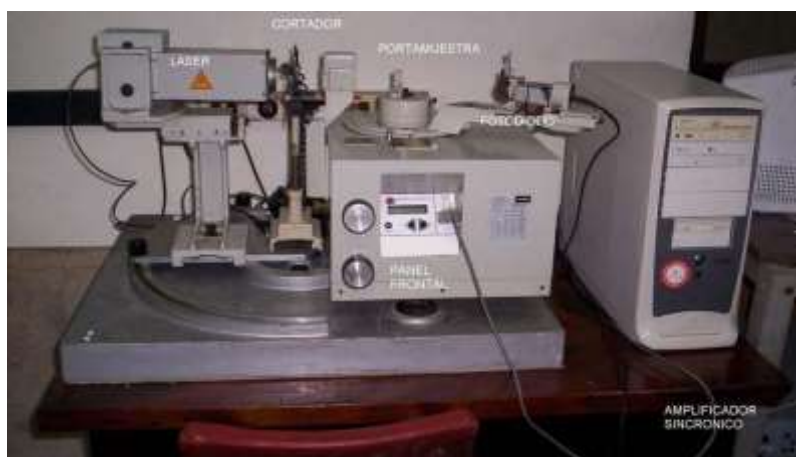
Figura 59. Perfilómetro láser Lehmann (Lehmann Mess-Systeme AG Baden-Dättweil)
