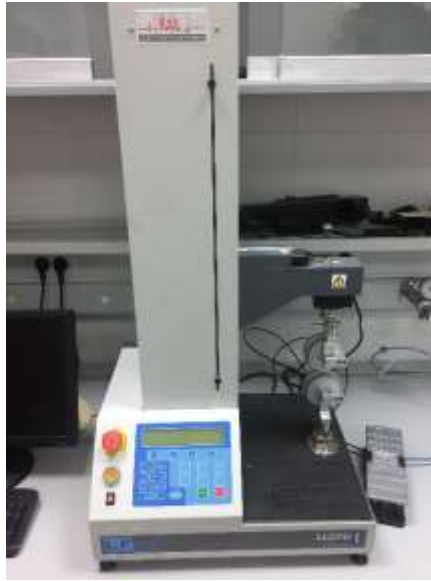
Figura 51. Equipo universal de ensayos LF Plus (Lloyd Instruments)
