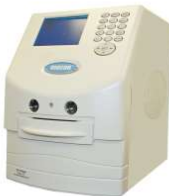
Figura 57. Equipo de medida de OTR Mocon OX-TRAN 1/50 (Mocon)
