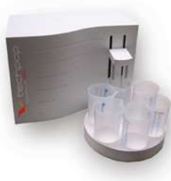
Figura 27. Analizador de fibras MorFi Compact (TechPap)
