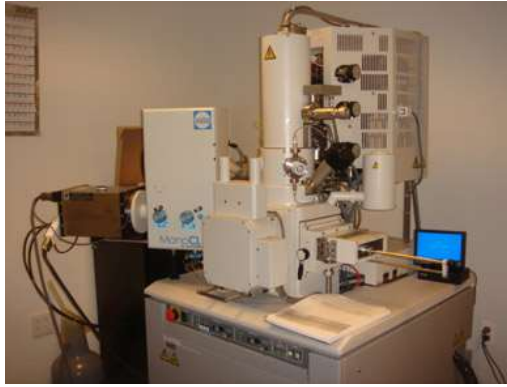
Figura 43. Microscopio electrónico de barrido de emisión de campo S-4700 (Hitachi)
