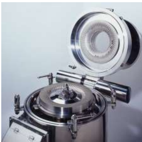
Figura 36. Molino de fricción ultrafino MKZA6-2 (Masuko Sangyo Co.),
