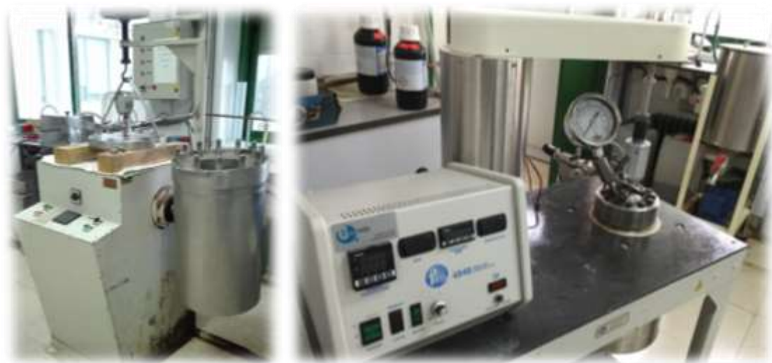
Figura 28. Reactores para proceso de pasteado. Izquierda: Reactor de 15 L; derecha: Reactor de 1,9 L
