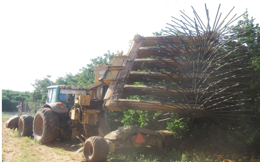
Figura 1.7. Disposición de las varas en el interior de la copa en un sacudidor de copa lateral arrastrado (OXBO 3210).
