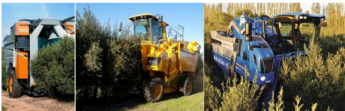
Figura 1.4. Sistemas de recolección mecanizada comerciales basadas en sacudidores de copa para plantaciones en seto estrecho. Izquierda: cosechadora cabalgante arrastrada Pellenc CV5045 (Pellenc, s. f.), central: cosechadora cabalgante autopropulsada Gregoire G10.330 (Gregoire, s. f.), derecha: cosechadora cabalgante autopropulsada New Holland Braud 9090X (New Holland, s. f.).
