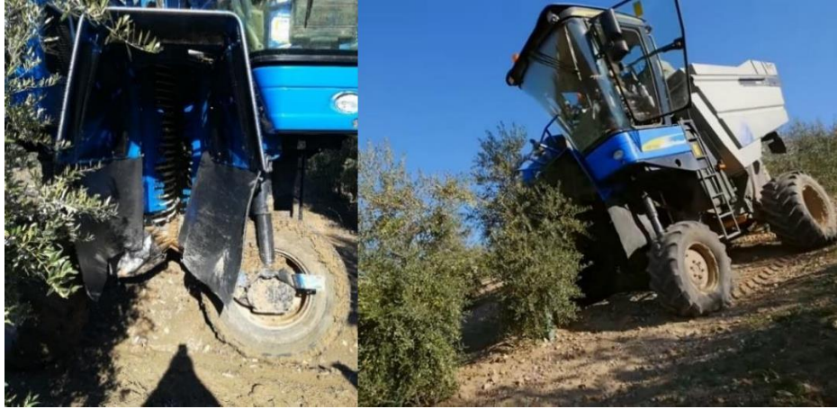
Figura 1.14. Detalle del sistema de maniobrabilidad (izq.) y nivelación longitudinal (dcha.) (Todolivo, 2016) de la cosechadora de seto estrecho.
