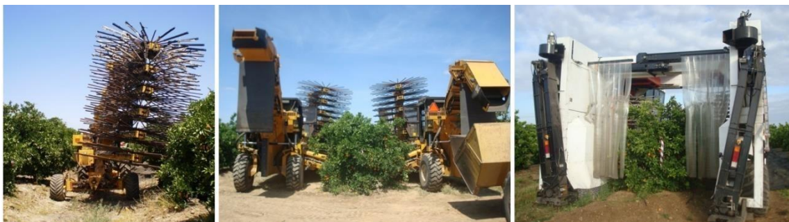
Figura 1.3. Sistemas de recolección mecanizada comerciales basadas en sacudidores de copa para plantaciones en seto ancho. Izquierda: sacudidor lateral de un lado (OXBO 3210), central: sacudidor lateral en tándem (OXBO 3220), derecha: cosechadora cabalgante de seto ancho (MAQTEC Colossus).
