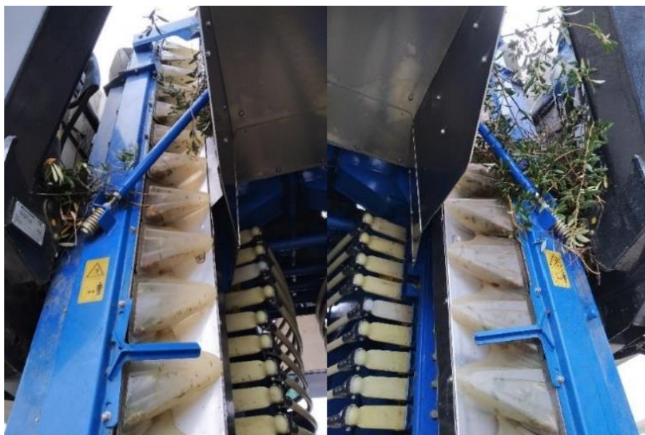
Figura 1.11. Detalle del sistema de elevación en cangilones y limpieza de ramas en el interior de una cosechadora cabalgante para seto estrecho
