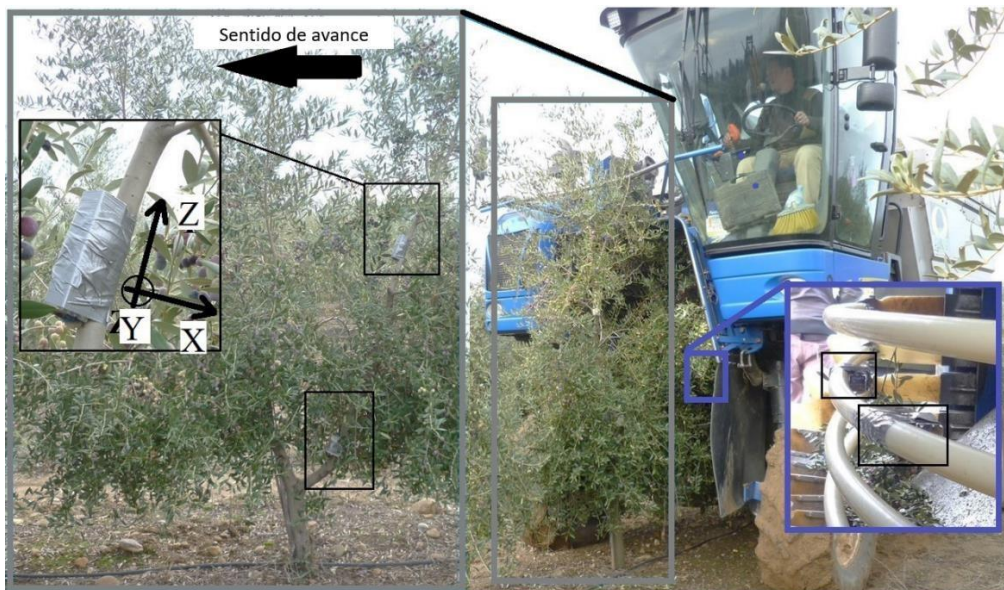
Figura 6.1. Ubicación de los acelerómetros en el árbol y la cosechadora cabalgante (Z: dirección vertical del árbol, X: dirección de avance de la máquina, Y: dirección de movimiento de las varas).
