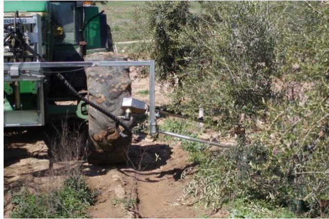
Figura 1.16. Poda mecanizada de las ramas bajas en un olivar en seto estrecho (Gil-Sierra, 2015).
