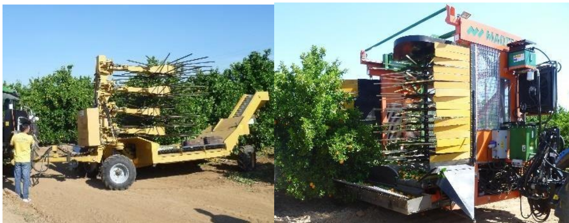
Figura 1.6. Prototipos de sacudidores de copa realizados en el CPP MECAOLIVAR empleados con distinta regulación y modificaciones menores para la recolección de cítricos en seto ancho.
