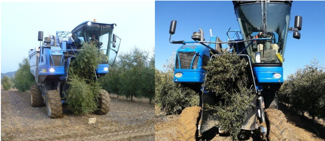
Figura 1.9. Cosechadora cabalgante en seto estrecho New Holland Braud VX7090.
