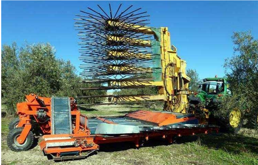
Figura 1.8. Prototipo de estructura de recogida, limpieza y almacenamiento de fruto acoplado al sacudidor de copa lateral arrastrado OXBO 3210.
