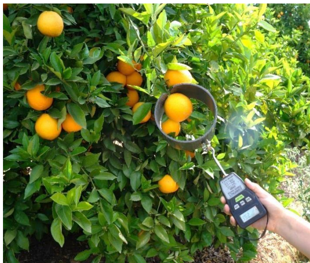
Figura 5.2. Medición de la fuerza de desprendimiento de las naranjas con mediante la prueba a tracción.
