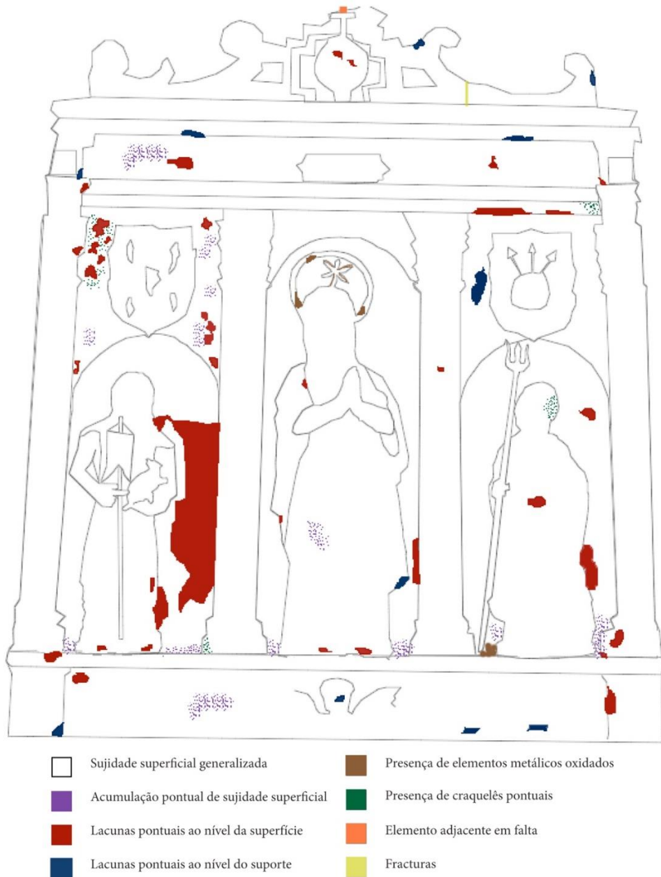
Fig. 22: Mapeamento de danos e patologias existentes no altar. Elaboração própria.
