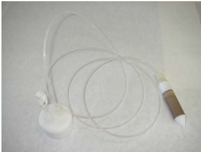
Imagen II.17. Tomamuestras de succión conectado al tapón de doble entrada.
