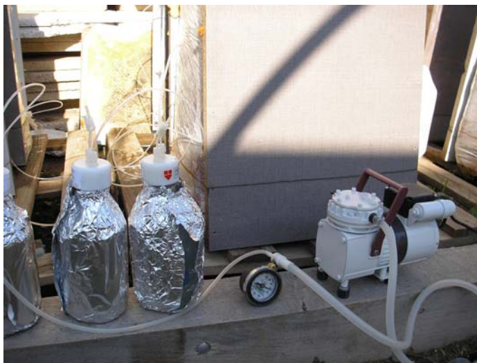
Imagen II.22. Bomba haciendo vacío en el conjunto botella-sonda.
