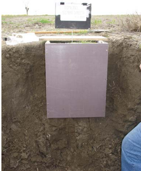
Imagen II.7. La anterior con la aplicación de la espuma poliuretano y empezando la hendidura trasera para la cuarta cara de la columna.
