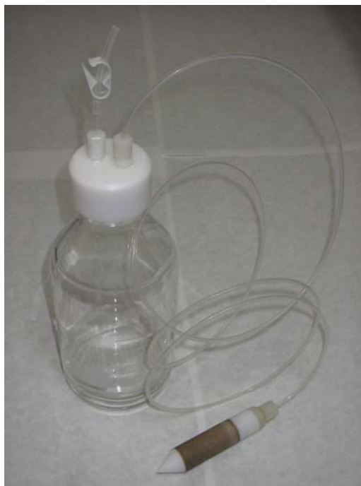
Imagen II.18. Tomamuestras de succión conectado mediante el tapón de doble entrada al recipiente donde se recoge la muestra.
