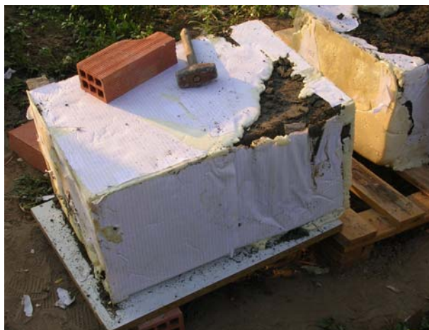
Imágenes II.10, II.11 y II.12. Diferentes caras de las muestras inalteradas sin plancha de madera y antes de reforzar la capa de poliuretano.
