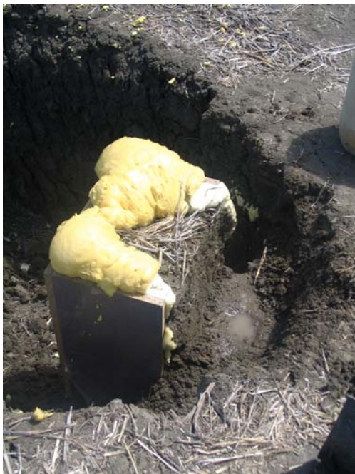
Imagen II.7. La anterior con la aplicación de la espuma poliuretano y empezando la hendidura trasera para la cuarta cara de la columna.
