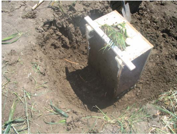
Imagen II.8. Terminada la cuarta cara del terrón. Preparada para fijar la plancha de madera a las otras tres.
