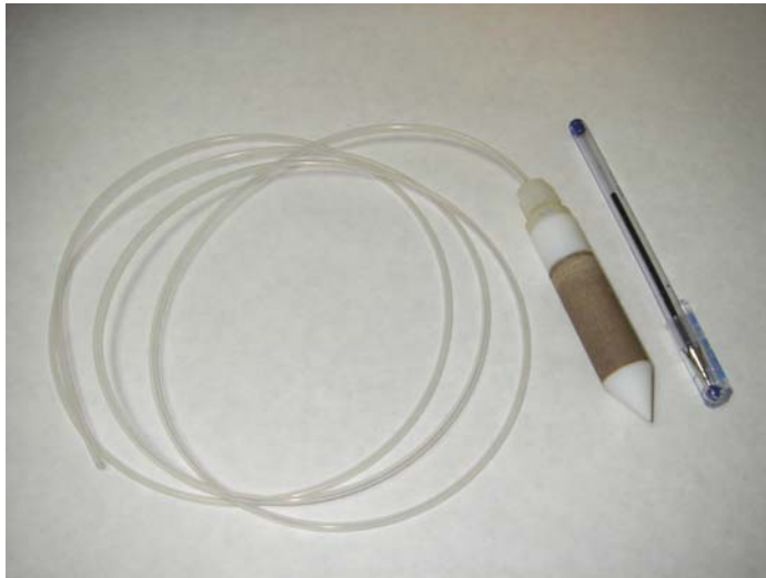
Imagen II.16. Tomamuestras de succión, equipados por una cápsula de cuarzo prolongada por un tubo de teflón.
