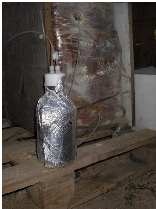
Imagen II.21. Sonda conectada al recipiente protegido con papel de aluminio de la luz solar.
