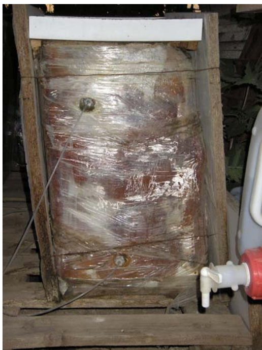
Imagen II.20. Dos sondas pinchadas en la misma cara de una muestra a diferentes profundidades.
