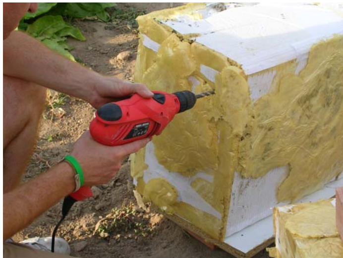
Imagen II.14. Realización de agujeros en la base para permitir el drenaje.
