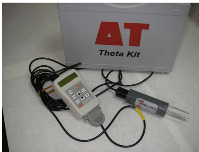
Imagen II.23. Modelo de TDR usado en este estudio. Thetaprobe ML2x con un datalogger HH2 moisture meter (Delta-T Devices. Cambridge, England)
