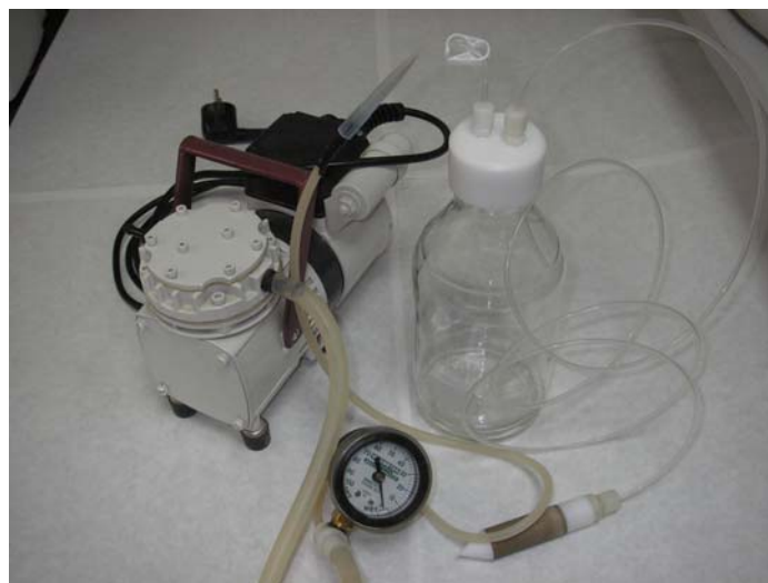
Imagen II.19. Equipo de succión completo: Sonda de teflón-cuarzo, tapón de doble entrada, recipiente y bomba de vacío.
