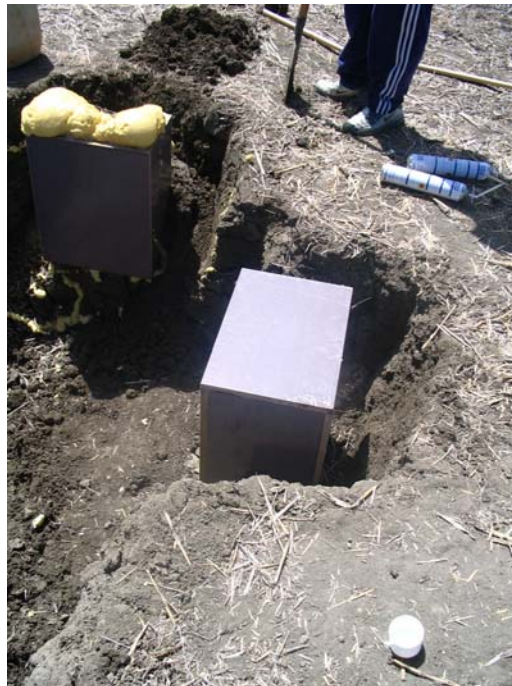
Imagen II.9. La columna con la cuarta y la quinta cara ya cubiertas y preparada para “cortarla” y obtener la muestra inalterada de suelo.
