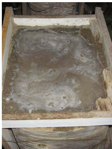
Imagen III.4. Muestra inalterada regada hasta humedad de saturación.
