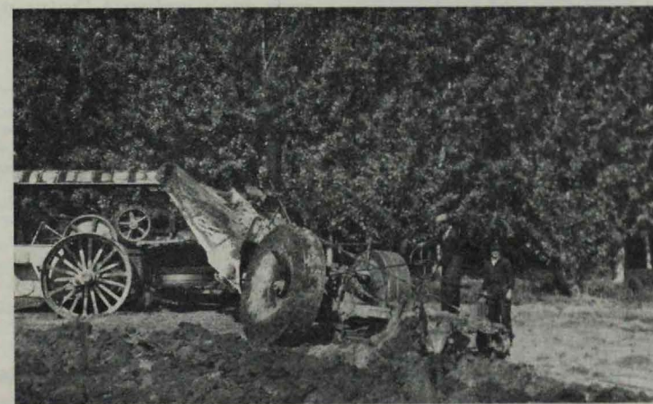
Une charrue de 4.500 kg. labourant à 0,80 m. de profondeur (Exploitation de la Viscosa).
