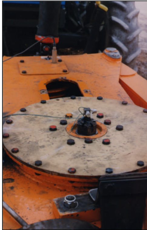
Figura 24. Ubicación de los acelerómetros en la cabeza vibradora.
