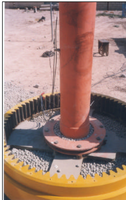
Figura 27. Poste móvil. Detalle de la unión tubo de acero-base.
