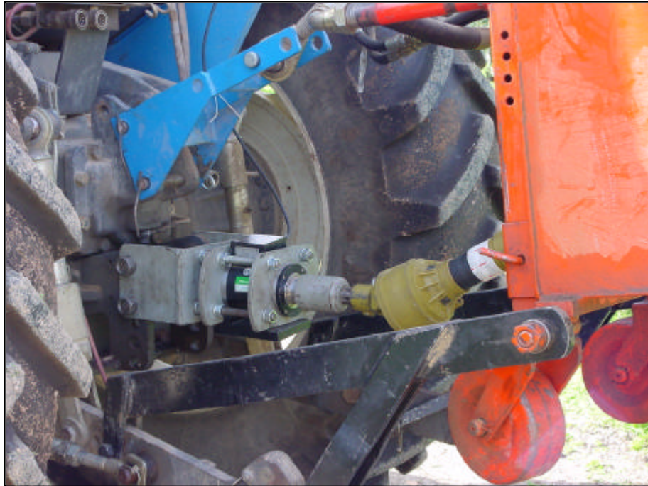
Figura 8. Sensor de par y velocidad angular de la toma de fuerza. Variante 1.
