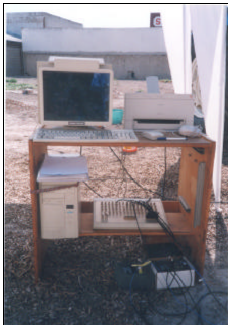
Figura 17. Sistema de Adquisición de Datos. Variante 1. Ordenador (izquierda), caja de entrada a la tarjeta y acondicionador de acelerómetros (derecha).
