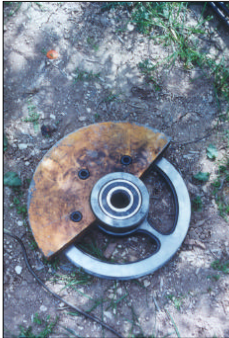
Figura 31. Masa excéntrica y polea utilizada en los ensayos.
