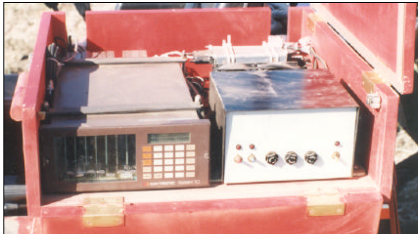
Figura 23. Sistema de acondicionamiento y transmisión de datos: “Datalogger”(izquierda) y unidad de alimentación y telemetría (derecha).
