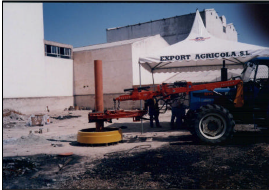
Figura 26. Poste móvil diseñado para el ensayo de vibradores.
