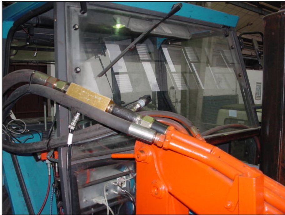
Figura 5. Sensores de caudal y presión para la medida en el motor hidráulico.
