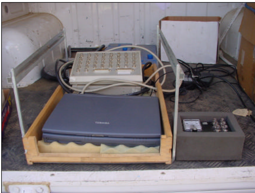
Figura 18. Sistema de Adquisición de Datos. Variante 2. Ordenador portátil, caja de entrada a la tarjeta (izquierda) y acondicionador de acelerómetros (derecha).
