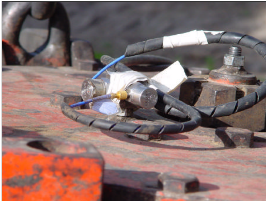
Figura 10. Medida de la aceleración longitudinal y transversal en la cabeza vibradora. Detalle de la colocación de los acelerómetros.
