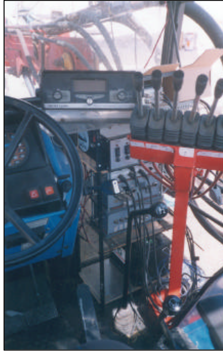
Figura 13. Sistema de Acondicionamiento. Variante1. Ubicación dentro del tractor (de arriba a abajo: “Caja Tractor”, módulos de acondicionado y batería de alimentación).
