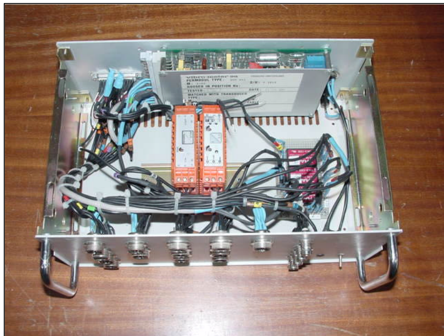
Figura 15. Sistema de Acondicionamiento, Variante2. Vista interior.
