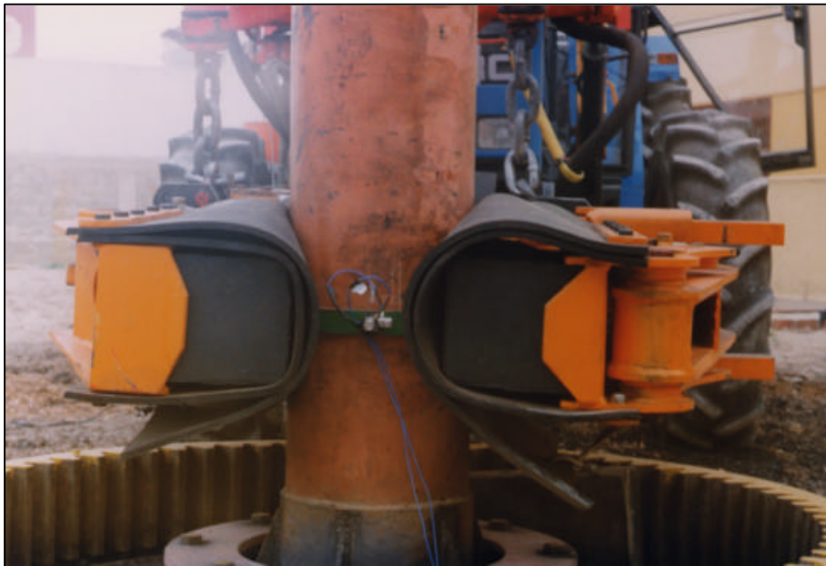
Figura 24. Ubicación de los acelerómetros en la cabeza vibradora.
