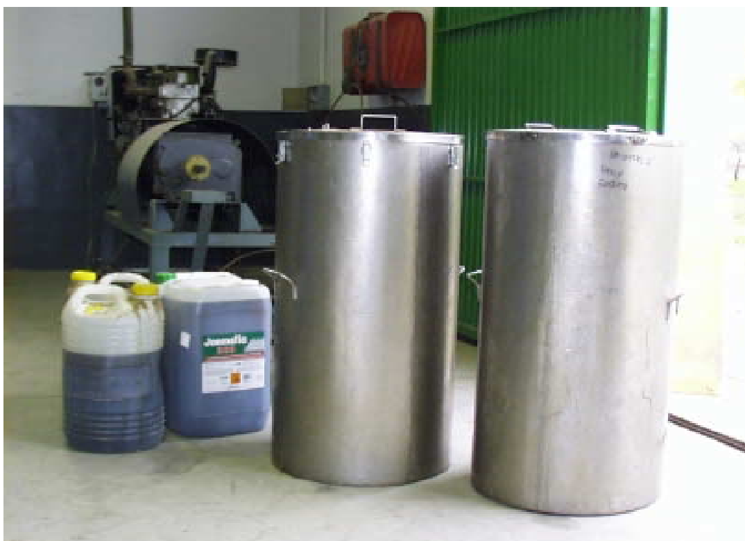
Figura 51. Productos de la reacción. La glicerina se almacenó en los bidones transparentes (izquierda); los ésteres metílicos en los bidones de acero (derecha)
