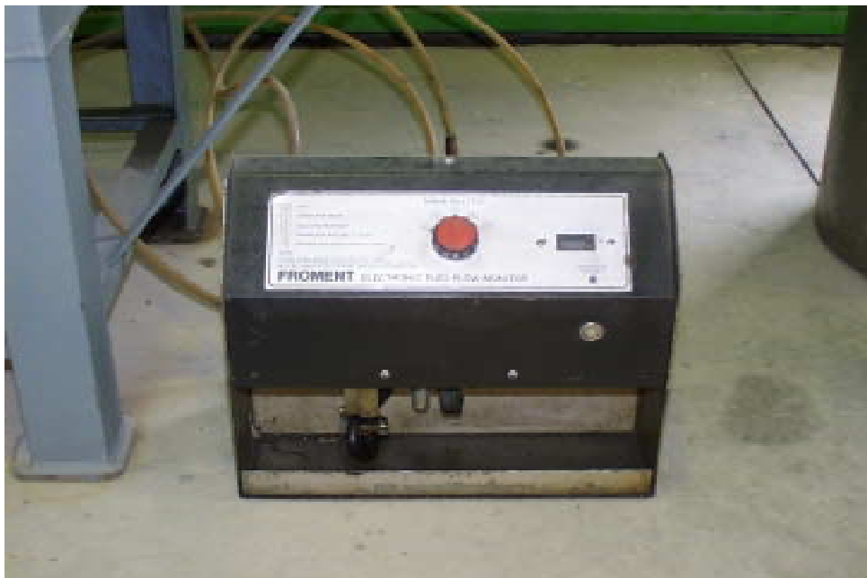
Figura 22. Medidor de consumo de combustible
