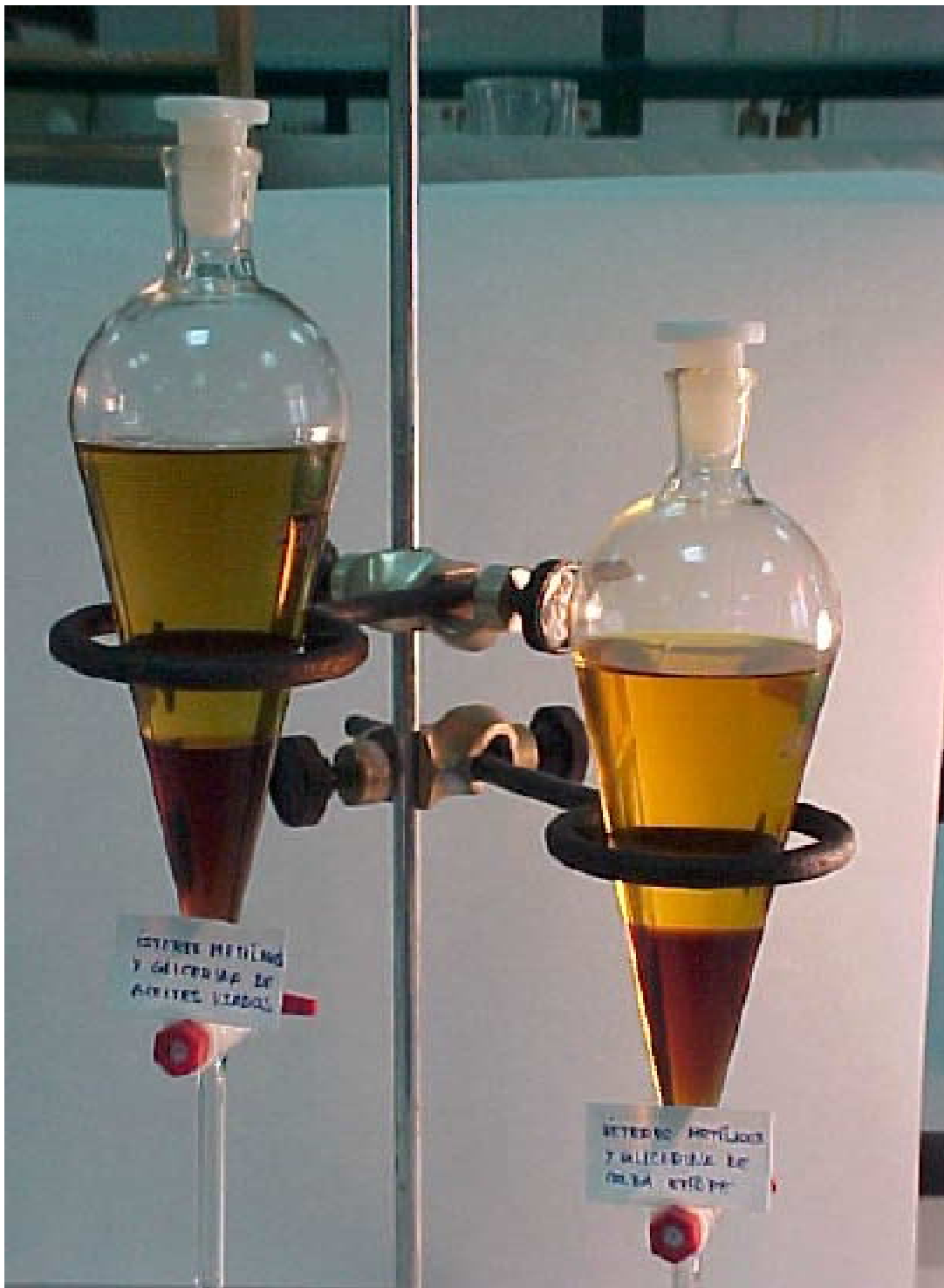
Figura 45. Productos de la reacción de transesterificación de los aceites usados y de los de colza etíope sin ácido erúico (de izquierda a derecha)
