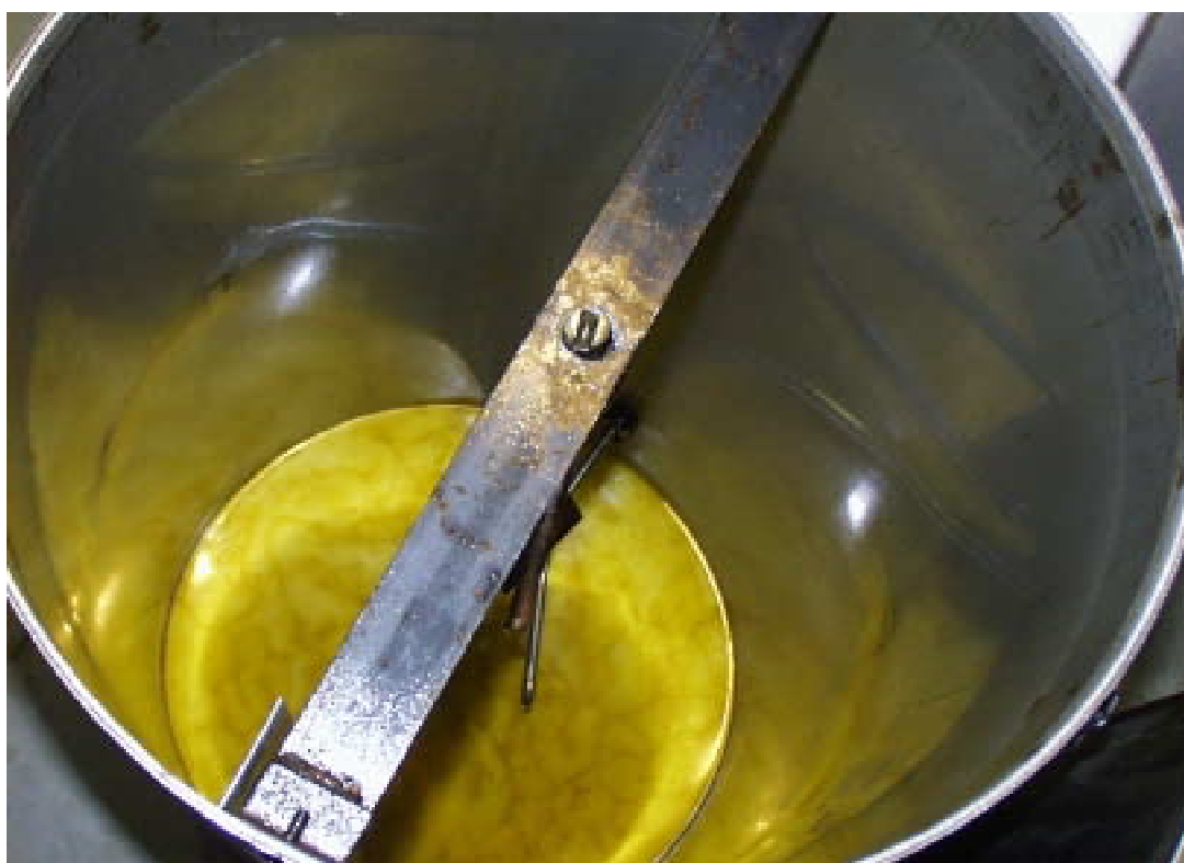
Figura 50. Saponificación del aceite en el reactor tras lavar los ésteres con agua destilada
