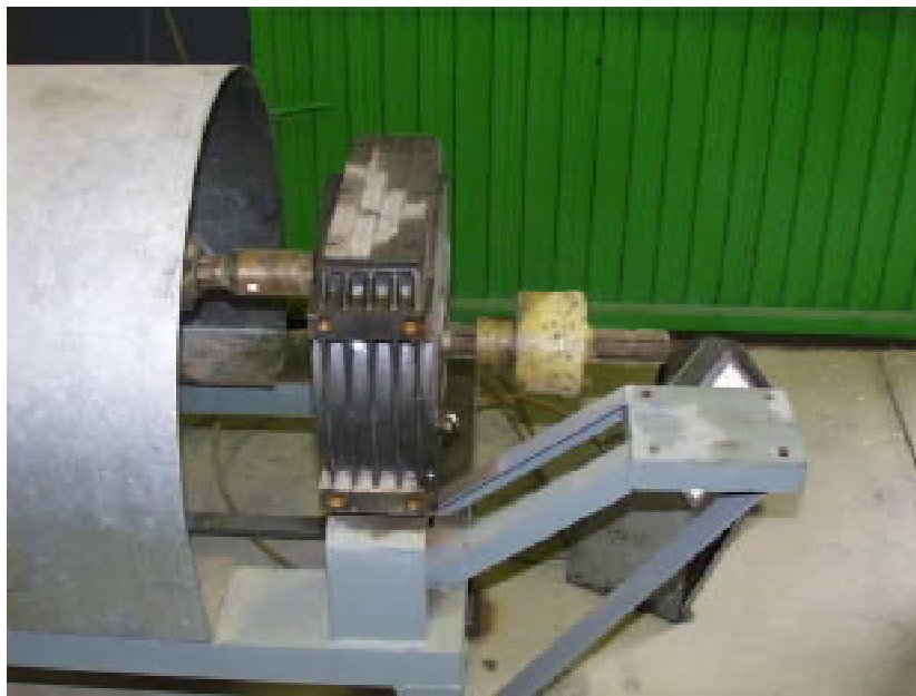
Figura 19. Reductor que permite acoplar el eje del motor con el freno dinamométrico
