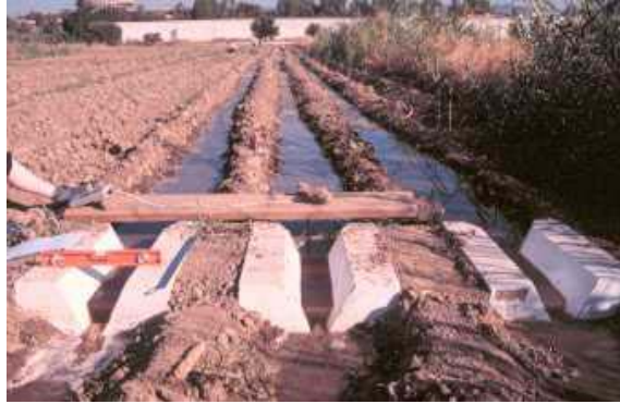
Figura 3.3. Aforadores situados en la cola de los surcos.
