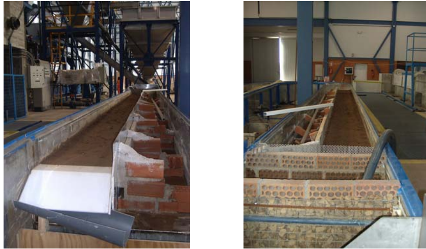
Figura 5.3. Canal relleno de suelo y estructura de remanso en el extremo de entrada de agua en la cabecera.
