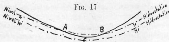
Si el nivel hidrostático desciende en el verano á N' H' no habrá encharcamientos ni corriente superficial en la depresión que forma el terreno en A C B, pero si se suceden lluvias de importancia y el nivel llega á elevarse del punto C, ocupando por ejemplo la posición N H, habrá una serie de manaderos que darán sus aguas en la superficie A C B al cauce indicado, hasta que desecadas las partes más altas del terreno por tal drenado descienda de nuevo el nivel al punto C.
