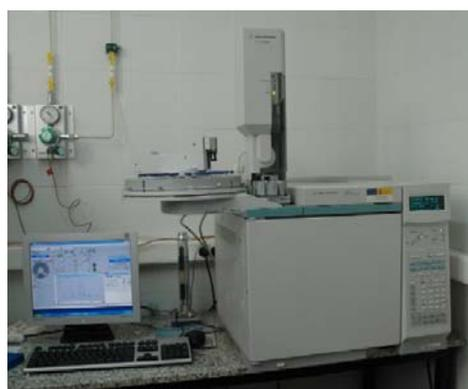
Foto 20. Cromatógrafo de gases.
